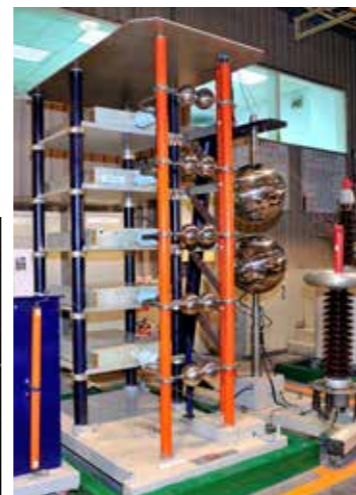
衝擊波測試 Lightning impulse test
